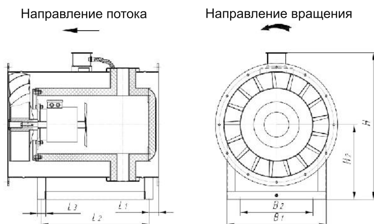
Рис. 261. Габаритные и присоединительные размеры осевых вентиляторов дымоудаления ВОДм-ДУ.
