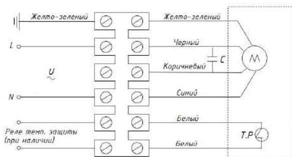
Схема подключения однофазного двигателя
