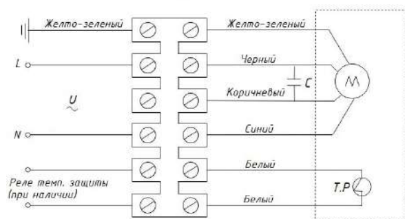
Схема подключения однофазного двигателя
