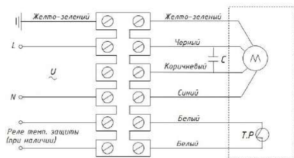
Схема подключения однофазного двигателя
