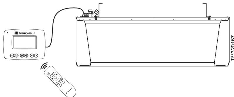
Конструкция воздушно-тепловых завес может состоять из одного вентиляторного блока или нескольких в зависимости от их длины, серии и модели. Завесы с условной длиной 1 метр включают один вентиляторный блок, 1,5 и 2 метра - два вентиляторных блока и 2,5 метра - три вентиляторных блока.
