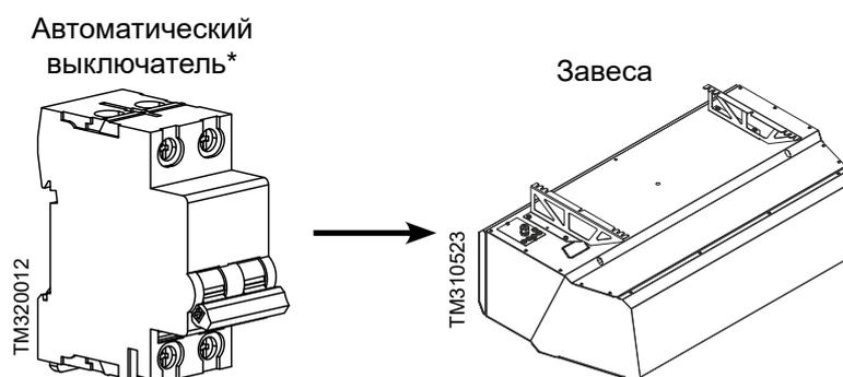
\* На рисунке изображён двухполюсный автоматический выключатель для подключения однофазной завесы.
